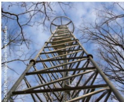
Tour de 35 mètres installée dans la forêt de Barbeau (FR) pour la mesure des flux de carbone et d'eau entre un écosystème forestier et l'atmosphère.
