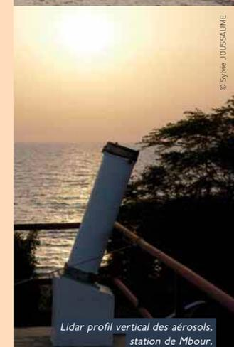
Lidar profil vertical des aérosols, station de Mbour.
